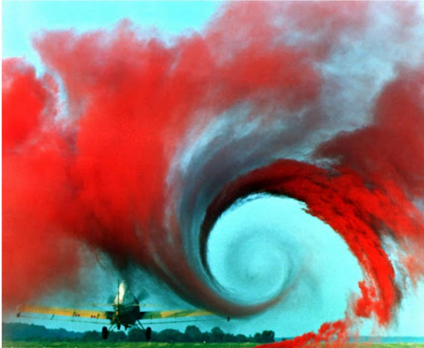
Sillage derrière une aile d'avion
