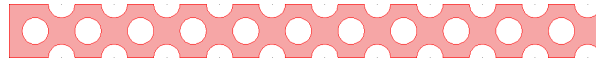
FIGURE 3 – Milieu homogène \eta dont les dimensions sont L=0.05625\text{m} , l=0.005\text{m} les cylindres ont un diamètre de 0.0025\text{m} .
