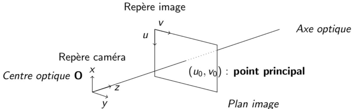
Intersection *axe optique* et plan image, notée  $(u_0, v_0) =$  **point principal**
