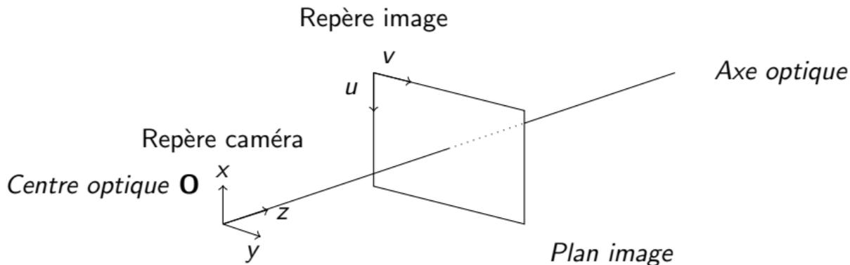
Droite passant par  $O$  et perpendiculaire au plan image = *axe optique*
