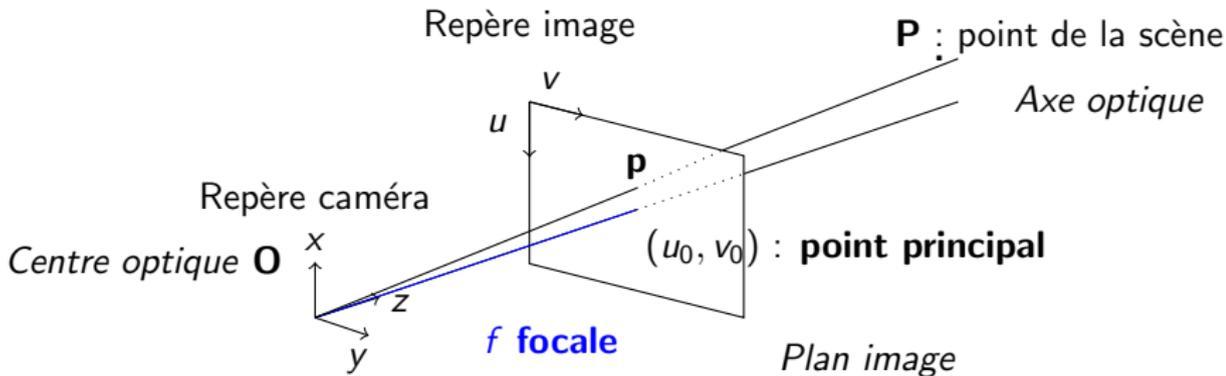
$\mathbf{M}$  = matrice de projection perspective des paramètres du modèle
