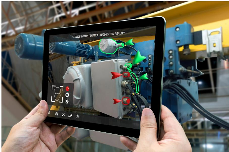
FIGURE 3 – L'application est capable de reconnaître la machine et ses pièces (ici en rouge et vert) et de montrer les opérations à effectuer à travers des animations graphiques.
