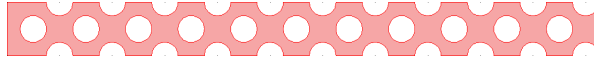
FIGURE 1 – Milieu homogène \eta dont les dimensions sont L=0.05625\text{m} , l=0.005\text{m} les cylindres ont un diamètre de 0.0025\text{m} .
